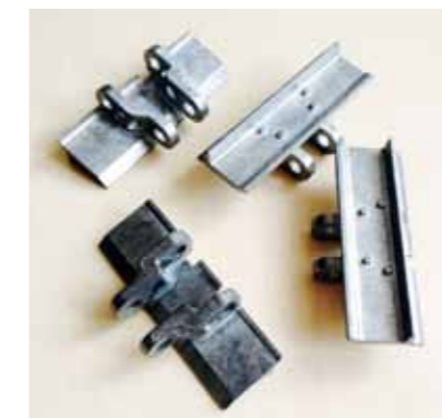
Die Einstieg-Metall-Kette wurde speziell für die Planierdraupe entwickelt
