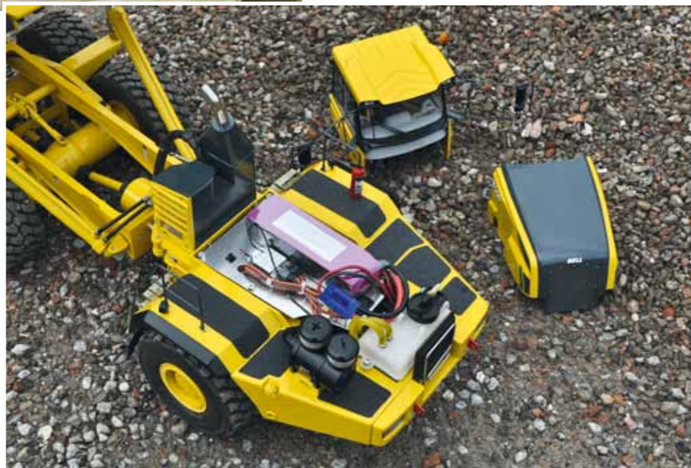
Empfänger, Akku und Hydrauliktank – im Motorraum herrscht nun wieder Ordnung
