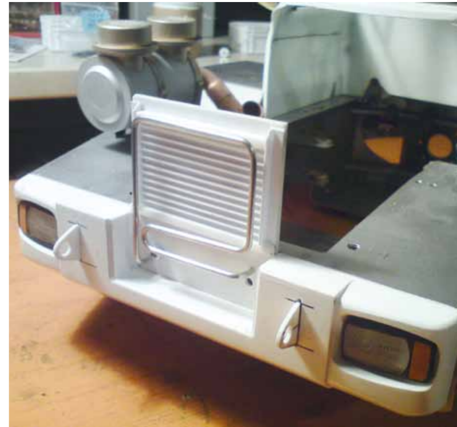
Eine Polystyrol-Platte hinter dem späteren Kühlergrill dient im Modell als Sichtschutz
