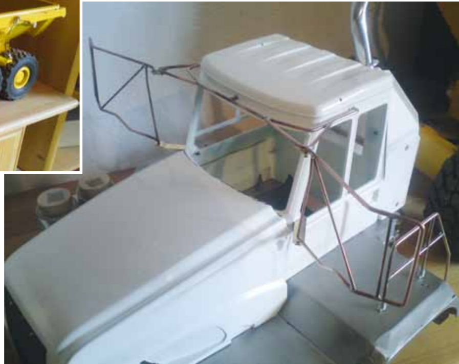
Diffizil: Viel Arbeit steckt in der Montage der filigranen Spiegelhalter
