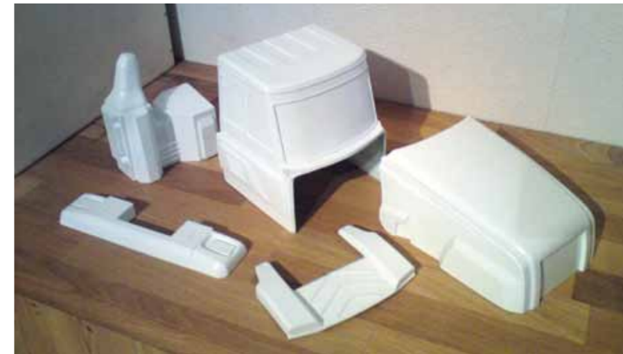
Die GFK-Teile des neuen B45D vor der Bearbeitung
