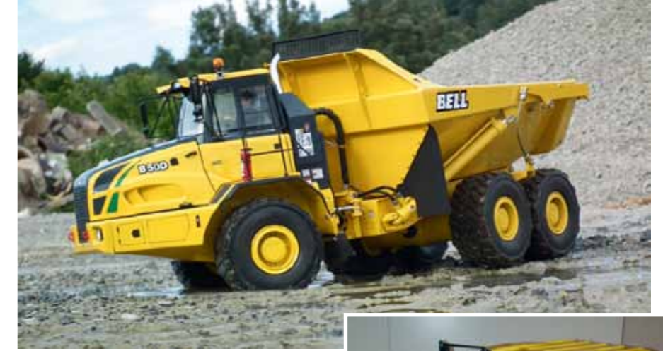
Der Bell B50D vor seinem Umbau. Im Unterschied zum B45D ist der Vorderwagen breiter und hat einen etwas höheren Motorraum
