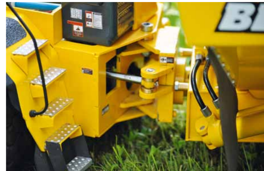
Der Heckbereich am Knickgelenk des alten Vorderwagens
