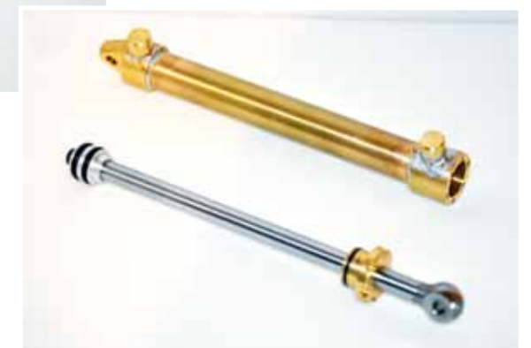
Kolben und fertig verlötetes Zylinderrohr. Letzteres ist allerdings noch nicht verschliffen
