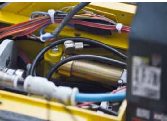
Der Zylinder eingebaut in Fumotecs Bell B50D. Hier übernimmt er die Lenkfunktion
